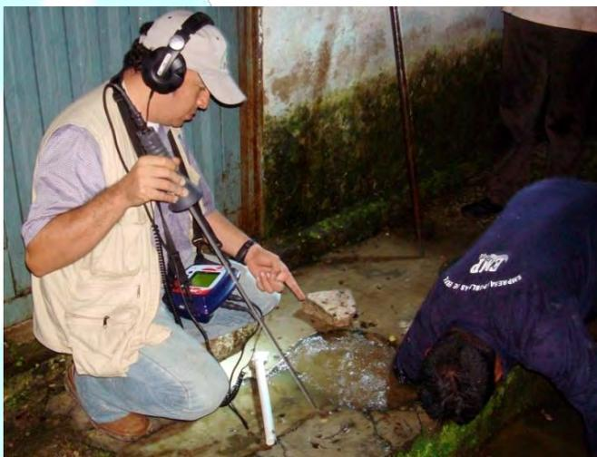
*Equipo de Geofonía (Alta Tecnología) durante la detección de una fuga de agua potable.*
